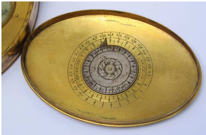
Ryc. 12. Zegar słoneczny (Z13) zaopatrzony w suwak księżycowy z obrotową tarczką wykonaną ze srebra, względnie posrebrzaną. Fot. Sylvain Gautier.
