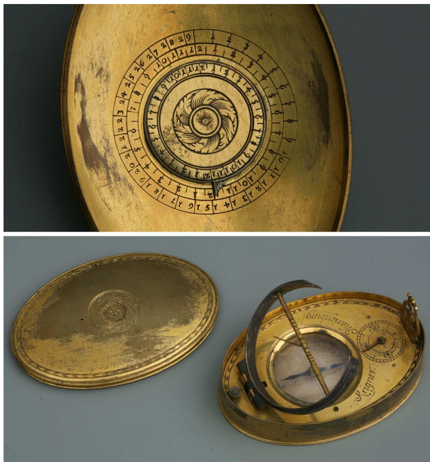
Ryc. 11. Zegar słoneczny ze zbiorów Muzeum Uniwersytetu Jagiellońskiego w Krakowie (Z2). Na górnym zdjęciu widoczny suwak księżycowy, umieszczony na wewnętrznej stronie wieka, służący do wyznaczania czasu słonecznego w oparciu o wskazania zegara oświetlonego światłem Księżyca. Fot. Grzegorz Zygiel, Muzeum Uniwersytetu Jagiellońskiego.
